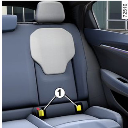
שתי הטבעות 1 מותקנות בין משענת הגב לבסיס המושב האחורי וניתן לזהות אותן לפי
