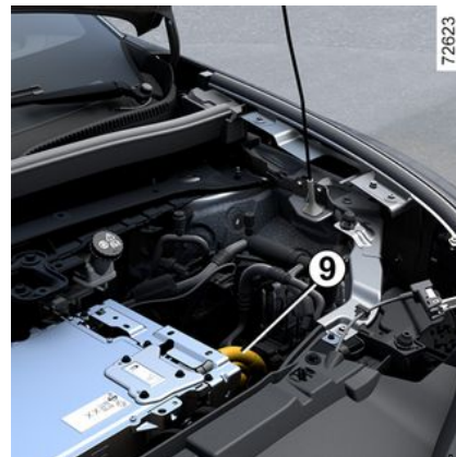
אפשר לזהות את המעגל החשמלי 'במתח גבוה' על פי הכבלים הכתומים 9 והרכיבים עם
