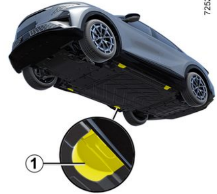
הרכב כולל ארבע נקודות הרמה ייעודיות 1 מתחת לרצפת הרכב.
