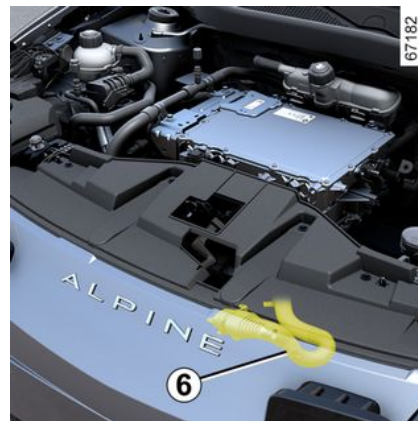
אפשר לזהות את המעגל החשמלי 'במתח גבוה' על פי הכבלים הכתומים 6 והרכיבים עם
