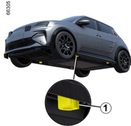
הרכב כולל ארבע נקודות הרמה ייעודיות 1 מתחת לרצפת הרכב.
