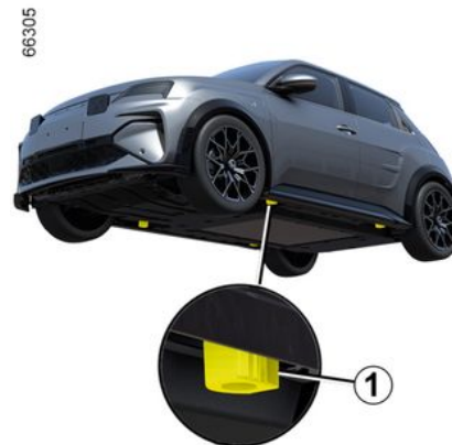
הרכב כולל ארבע נקודות הרמה ייעודיות 1 מתחת לרצפת הרכב.
