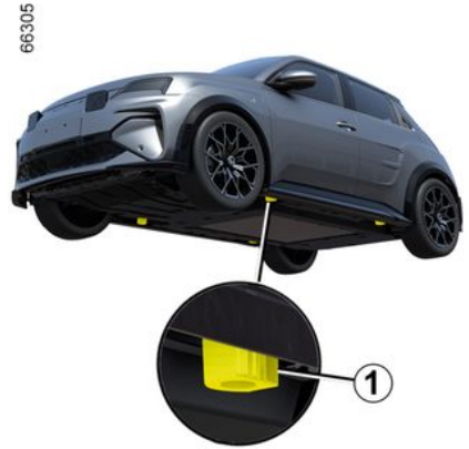
سيارتك مجهزة بأربع نقاط رفع مخصصة 1 تقع أسفل السيارة.
