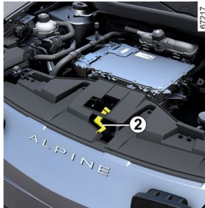
לשחרור הנעילה, יש לדחוף את הידית 2 שמאלה תוך הרמת מכסה המנוע.
